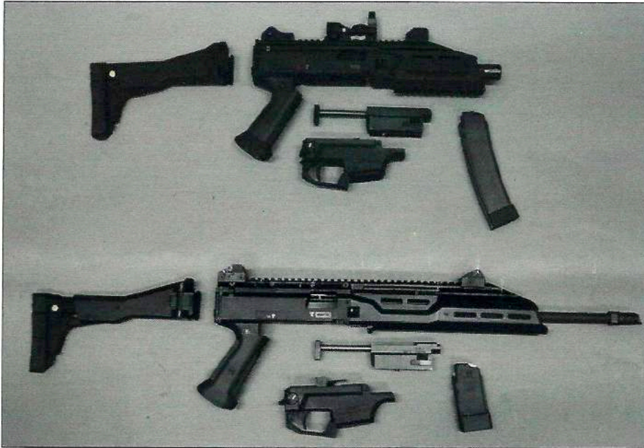
Abbildung 9: Vergleichsansicht rechte Seite, oben die vollautomatische „CZ Scorpion EVO 3 A1“, unten „CZ Scorpion EVO3 S1 Carbine C“, beide zerlegt in die jeweiligen Hauptgruppen
