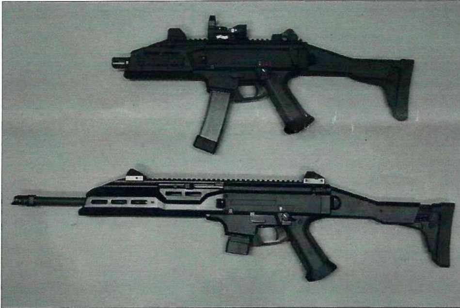
Abbildung 7: Vergleichsansicht linke Seite, oben die vollautomatische „CZ Scorpion EVO 3 A1“, unten „CZ Scorpion EVO3 S1 Carbine C“
